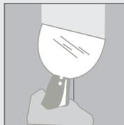
Aplique el JUNTEX con una capa delgada directamente sobre la unión, usando una espátula para juntas.
