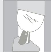
Cuando la primera capa esté seca al tacto, instale la segunda capa cubriendo la cinta unos 10 cms. a cada lado de la junta y espere a que seque completamente para instalar la tercera capa.
