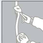
Inmediatamente embeba la cinta usando la espátula mientras el material esté fresco, presionando firmemente la espátula de manera de remover las burbujas de aire. Retire los excesos de producto.
